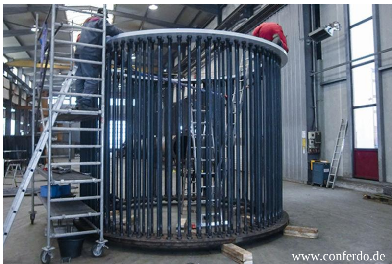
Abbildung 8-17: Ankerkorb zum Anschluss von Suction Bucket und Jacketstrebe
